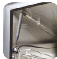
Многоточечный щуп с функцией нагрева
